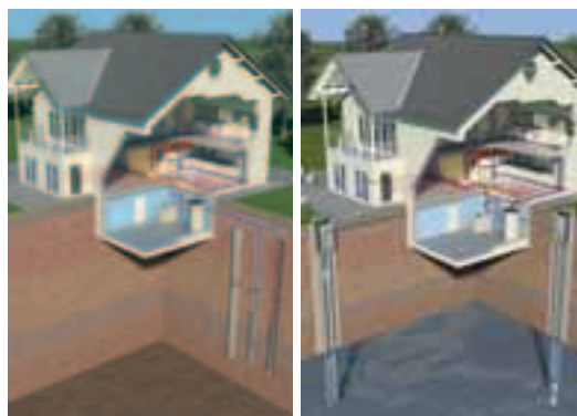
AQUATOP T: un modello per applicazioni con acqua di falda o con sorgente geotermica
